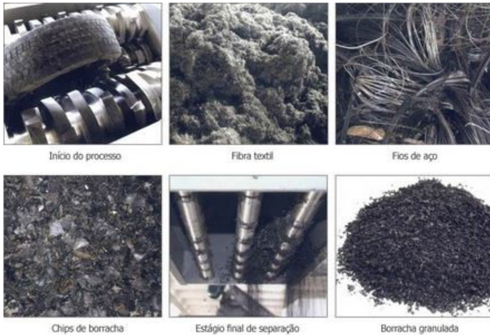
Figura 8 - Processo de Trituração de Pneus para composição de Asfalto Borracha
