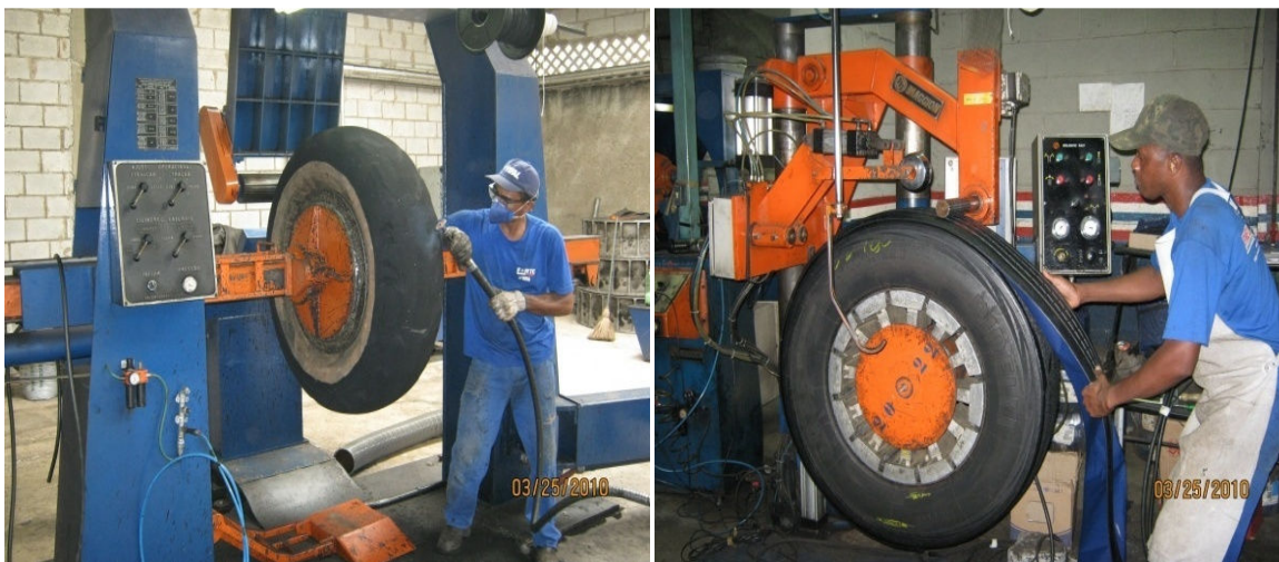
Figura 9: Raspagem e cobertura de um Pneu Recapado
