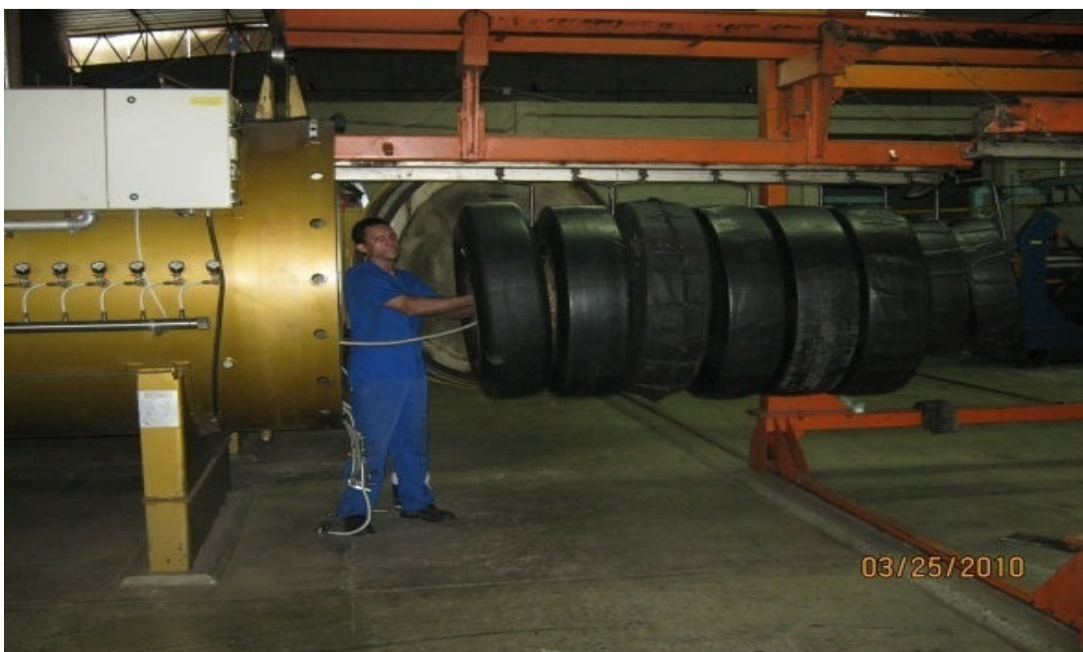
Figura 10: Pneus entrando dentro do Autoclave para receber alta pressão via temperatura.
