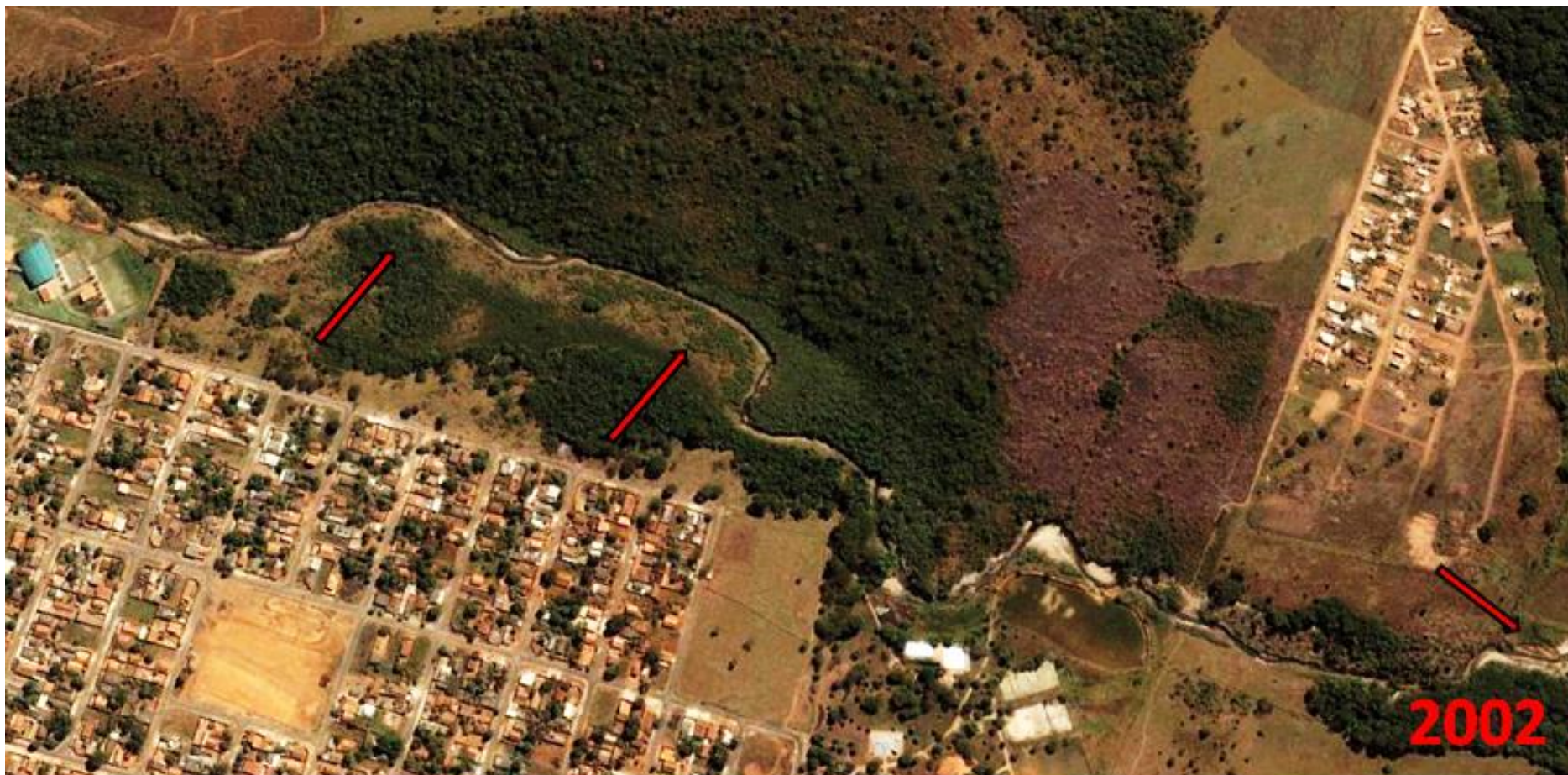
Figura 6 – Avanço de nível de assoreamento do leito do córrego nas proximidades do setor Papiilon Park, Aparecida de Goiânia, 2002.
